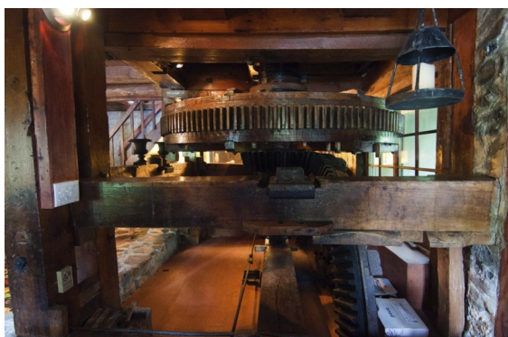
L'engrenage qui fait fonctionner les meules, etc. au moulin de Jean Leclerc
